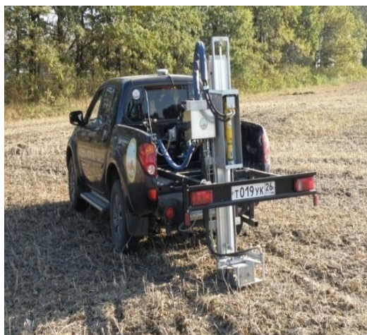
Mitsubishi L200 с автоматическим почвенным пробоотборником Nietfeld Duoprob 60
